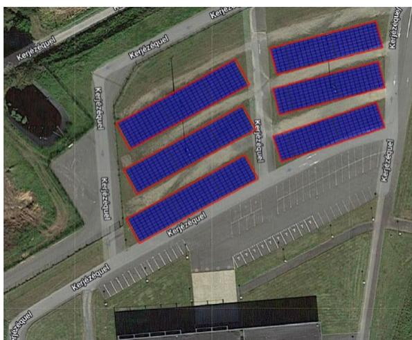
6 structures seront mises en place avec une puissance installée de 500kWc sur une surface de 2 443m<sup>2</sup>.
