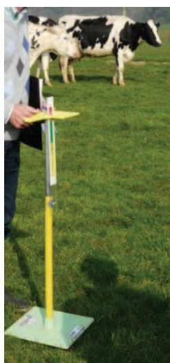
« l'herbomètre permet de mesurer la hauteur de l'herbe »
